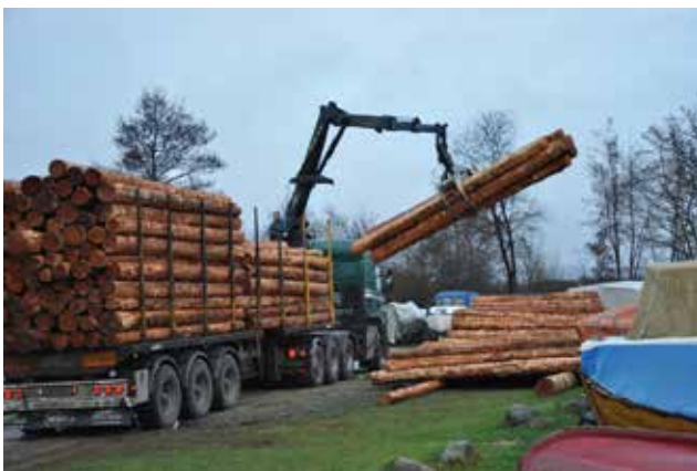
Til arbejdet skulle der anvendes 755 lærkestammer. Disse blev leveret successivt. Bemærk at stammerne var afbarket i modsætning til renoveringsarbejdet i 2007/08. Foto 18/12 2013.
